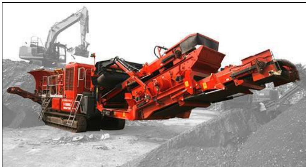
Figure 3 : Concasseur à impact mobile sur chenilles TerexR Finlay
